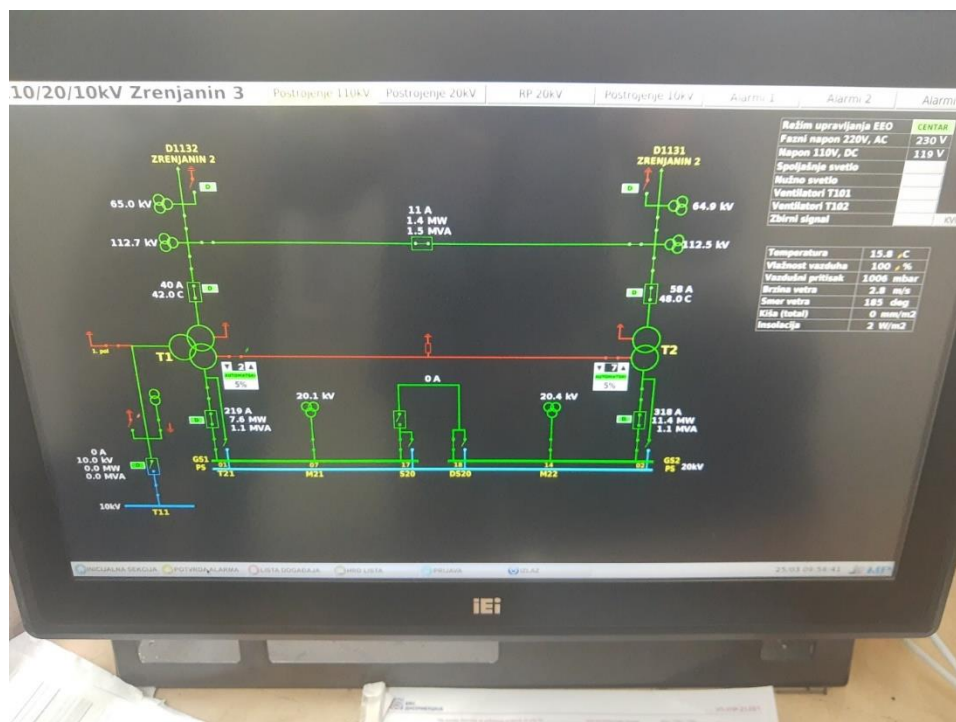
Slika 6: Neispravan podatak o položaju RS na T2
